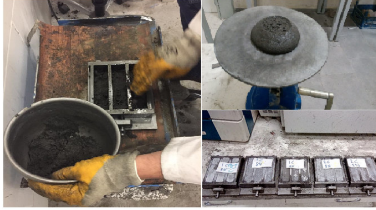
Şekil 1. Numune üretimi ve işlenebilirlik deneyi
