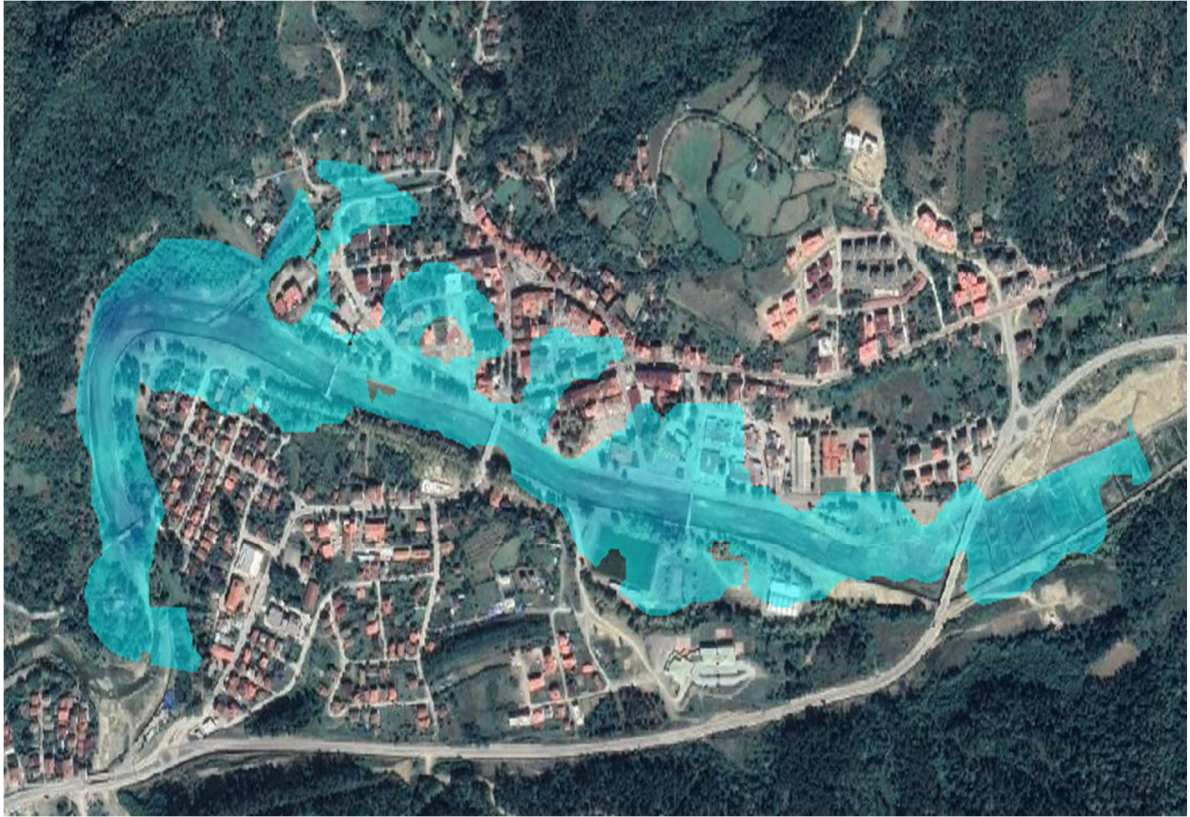
Şekil 4. HEC-RAS Analizi sonucunda elde edilen taşkın yayılımı
