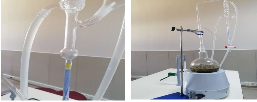
Şekil 2: Bitki Uçucu Yağı ve Su Distilasyon Apereyi
