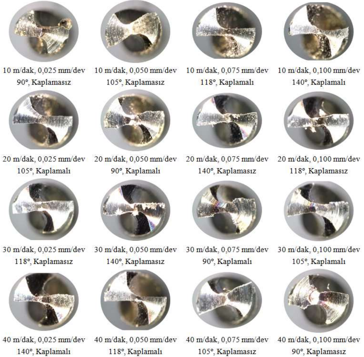
Şekil 4. Kesici takım aşınmaları
