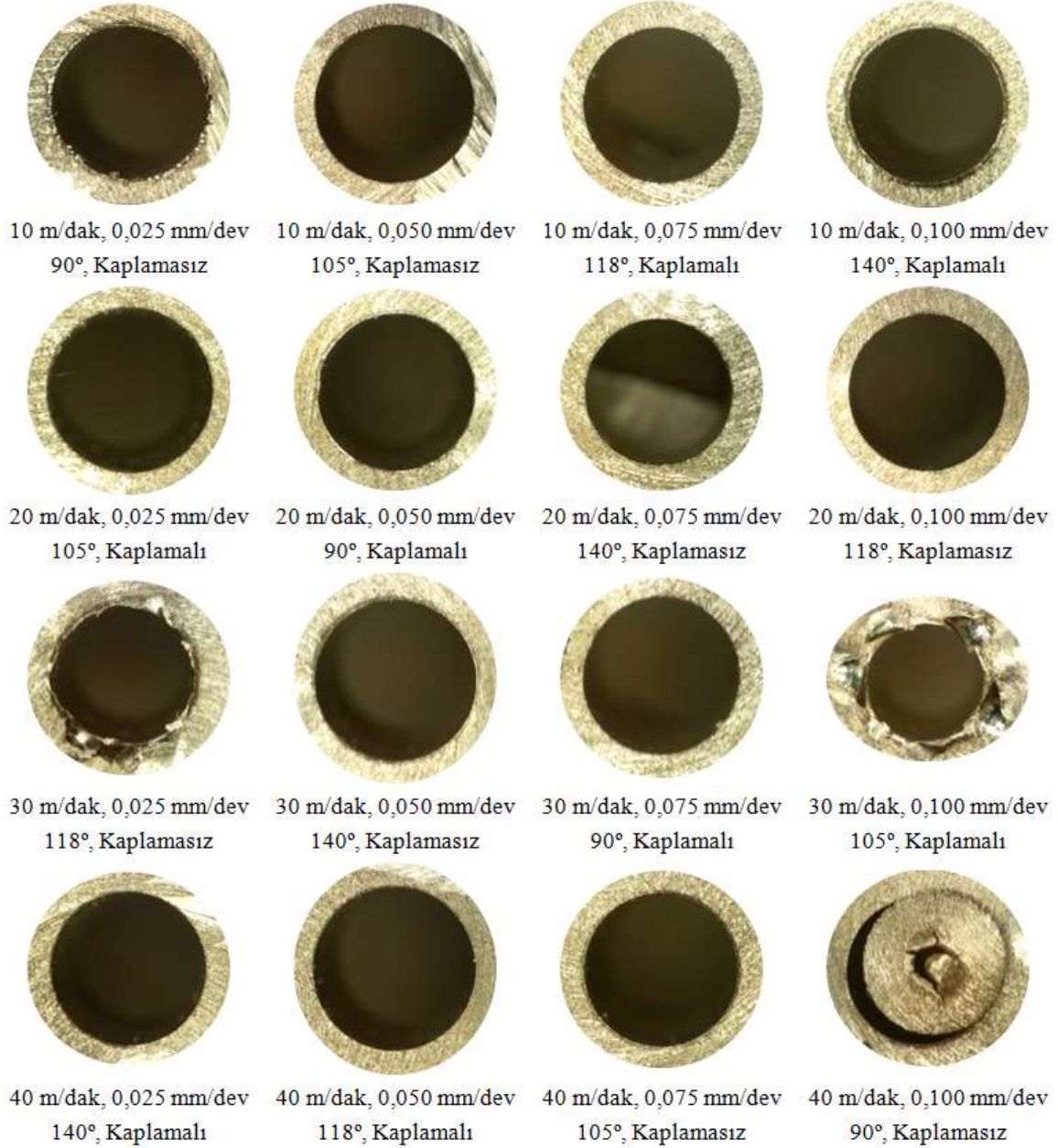
Şekil 6. Delik sonlarında çapak oluşumu
